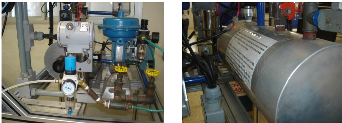
Figura 47 Planta da malha de controle de temperatura utilizada para testes.
