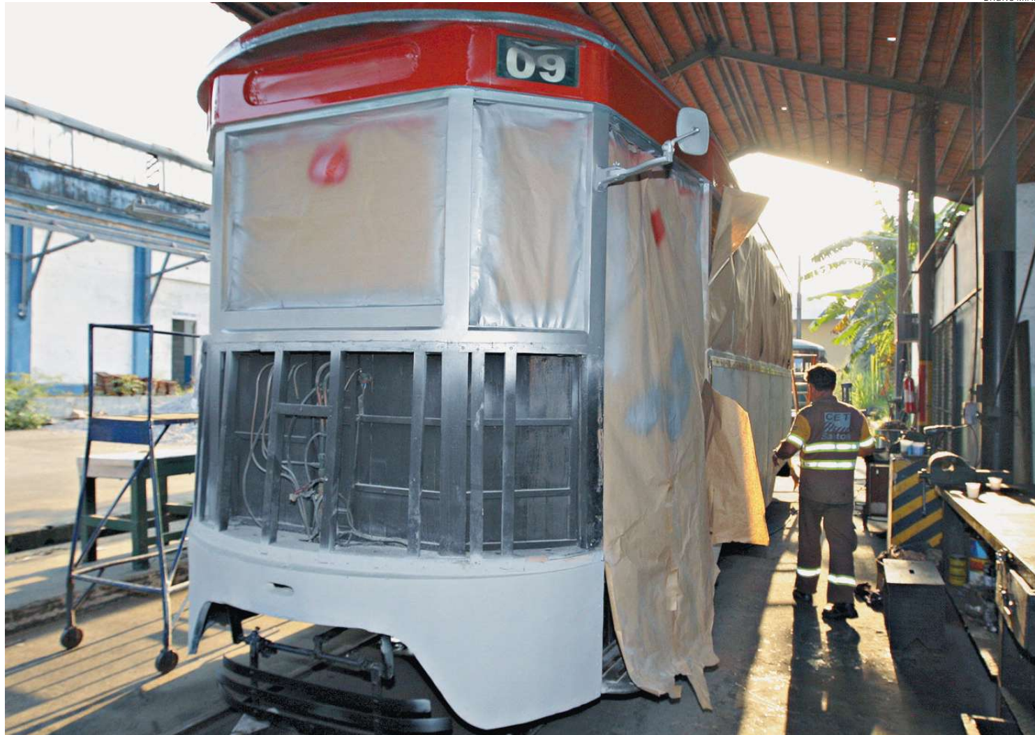
O bonde camarão já está recebendo as cores originais, que são o vermelho e o prata. O trabalho é realizado por funcionários da CET-Santos
